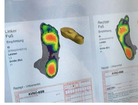
Der Fußscanner als Werkzeug für Diagnostik, Versorgung und Dokumentation.
